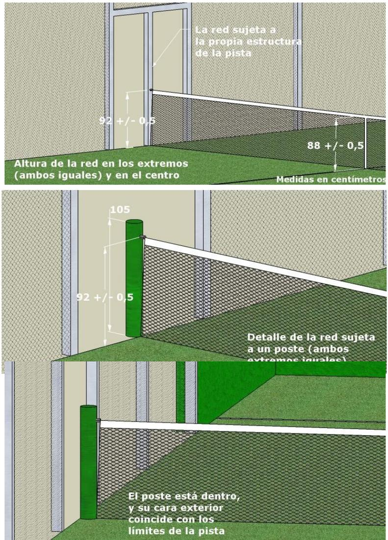
Los postes de la red tienen sus caras exteriores coincidiendo con los límites laterales de la pista (abertura, puerta o malla metálica). Pueden ser de sección circular o cuadrada pero tendrán sus aristas redondeadas.
