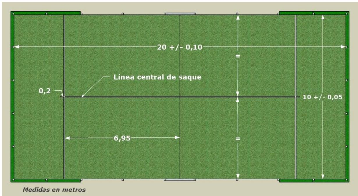
La altura mínima libre será de 6 metros en toda la superficie de la pista, sin que exista ningún elemento que invada dicho espacio (Ejemplo: focos). Para las nuevas construcciones se sugiere que la altura mínima libre sea de 8 metros en toda la superficie de la pista, sin que exista ningún elemento que invada dicho espacio.
